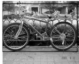
自行车的主要受力部 件均由薄壁钢管制成
