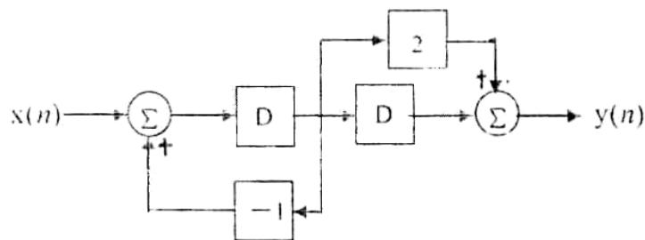
三、(20 分) 某离散 LSI 系统的转移函数  $H(z) = \frac{z^2 - 3z}{z^2 - 3z + 2}$ , 已知当激励为  $x(n) = (-1)^n u(n)$  时, 其全响应为  $y(n) = \left[ 2 + \frac{4}{3}(2)^n + \frac{2}{3}(-1)^n \right] u(n)$ . 求系统的零状态响应  $y_s(n)$  和零输入相应  $y_i(n)$ .
